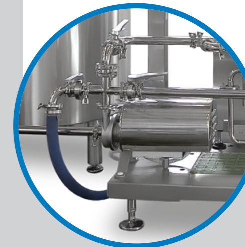
Dettaglio pompa di trasferimento/ Mixing pump
